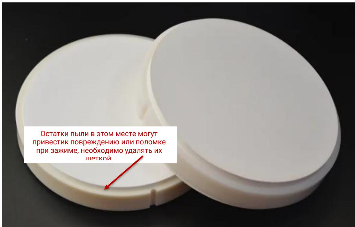
4. При затяжке зажима равномерно затягивайте все винты. Не затягивайте до конца один винт, предварительно не подтянув остальные винты. Неравномерное распределение прилагаемого усилия во время данной операции может вызвать повреждение заготовки или создать внутренние напряжения, которые могут привести к разрушению во время обработки.
