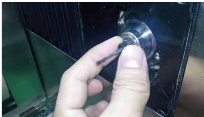
5. Вставьте новую фрезу в зажимной патрон, убедитесь, что ограничительное кольцо доходит до патрона, а затем затяните зажимной патрон, нажав на экране ручного режима кнопку «Collet» (Зажимной патрон). Ограничительное кольцо используется для того, чтобы обеспечивать соответствие установочной длины фрезы требованиям обработки. Не вставляйте фрезы в зажимной патрон или гнездо инструментального магазина без зажимного кольца. На данном этапе процедура замены фрезы считается завершенной.
